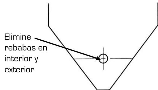
3. Pida a una persona que desde el interior del silo inserte el disco y el conjunto del vástago en el orificio.
